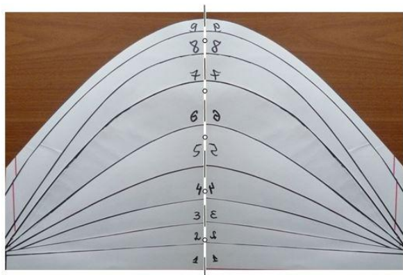
Рис.6. Общий вид (без показа отверстий) системы расположения всех жалюзи в целостной конструкции одного антигравитационного микроячееистого фильтра-жалюзи (частично раздвинутое состояние).
