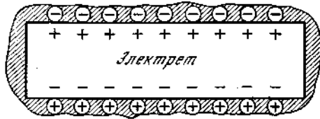
Рис. 50. Экранирование зарядов электрета ионами водной пленки
