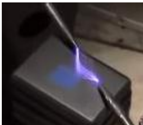
Фото.1. Геометрическое искривление высоковольтного разряда электричества под воздействием магнитного поля от находящейся под разрядником системы постоянных магнитов прямоугольной формы.
