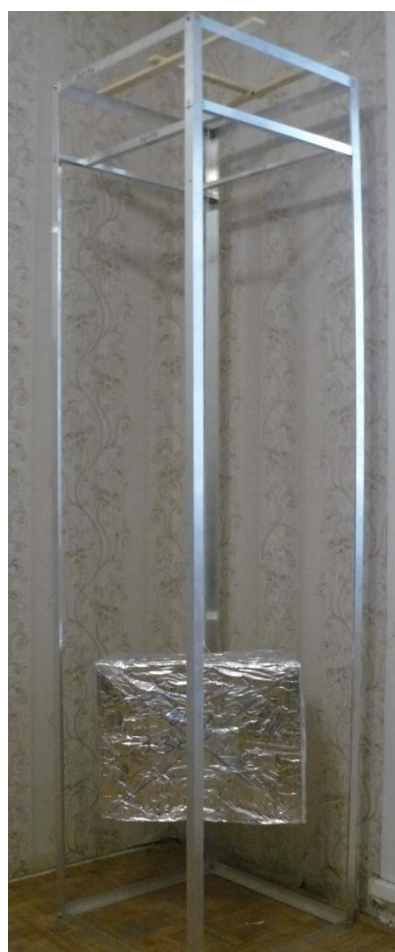
Фото 22. Правильная подвеска при которой датчик работает.
