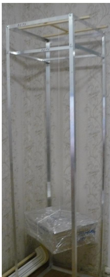
Фото.21. Подвеска датчика, при которой он эффективно не работает.
