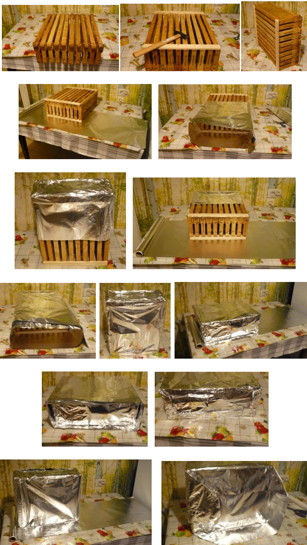
Фото.5 - 18. Последовательность изготовления датчика по регистрации ЭПС на основе пчелиных сот из 10-ти рамок от магазинов пчелиных ульев.
