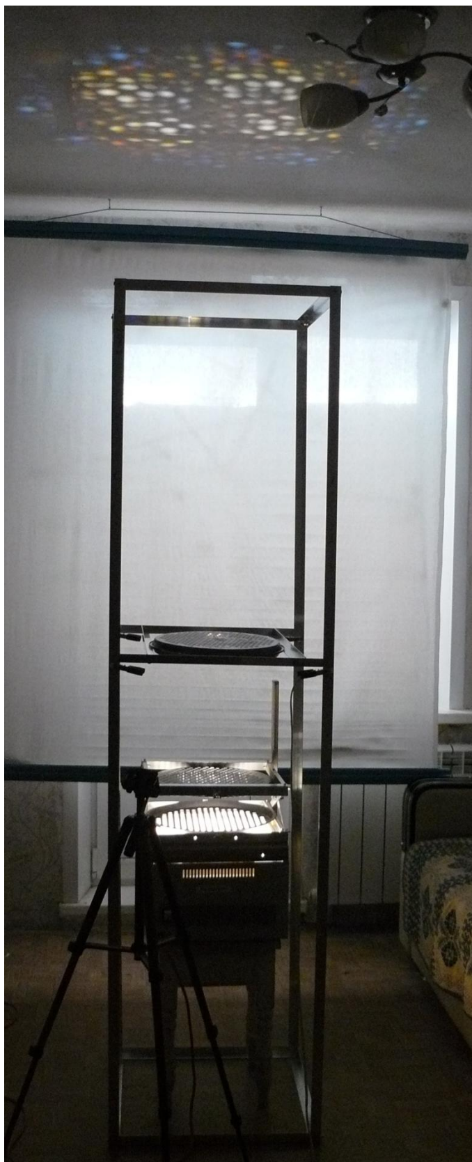
Фото. 49. Включенное устройство визуального наблюдения волновой картины и приспособление для многослойной фиксации сеточных структур и перфорированных объектов с видом на потолке полученного изображения от перфорированных, используемых для выпечки пиццы четырех жаровен жаровен.
