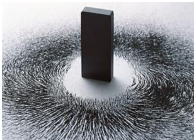
Рис. 16. Вид магнитных силовых линий постоянного магнита
