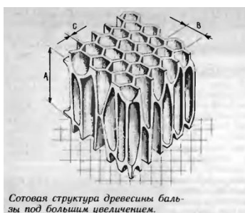
Фото. 4. Специфика внутренней полостной структуры древесины бальзы.
