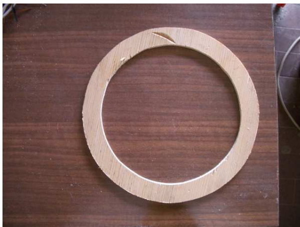
а - размеры кольца: внутренний диаметр - 18 см; внешний диаметр - 23 см; ширина кольца - 2,5 см; толщина кольца - 5 мм.
