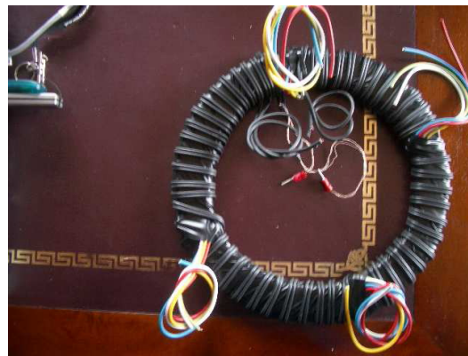
б - тороид в сборе без внешнего коллектора в - тороид в сборе с внешней катушкой-коллектором
