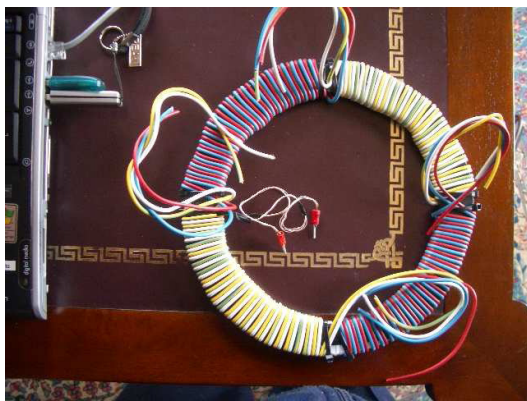
б - тороид в сборе без внешнего коллектора в - тороид в сборе с внешней катушкой-коллектором
