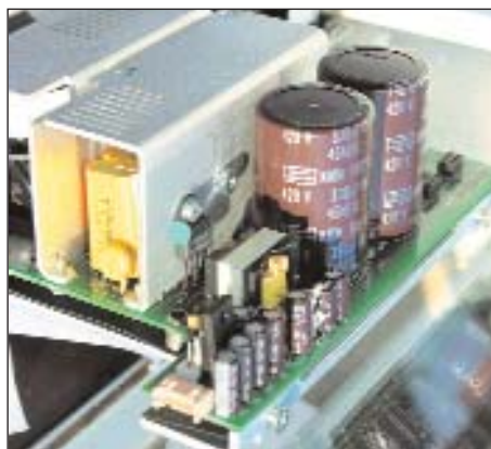
Рис. 5. Внешний вид каскада повышающего преобразователя источника питания с применением карбид-кремниевых диодов с барьером Шоттки
