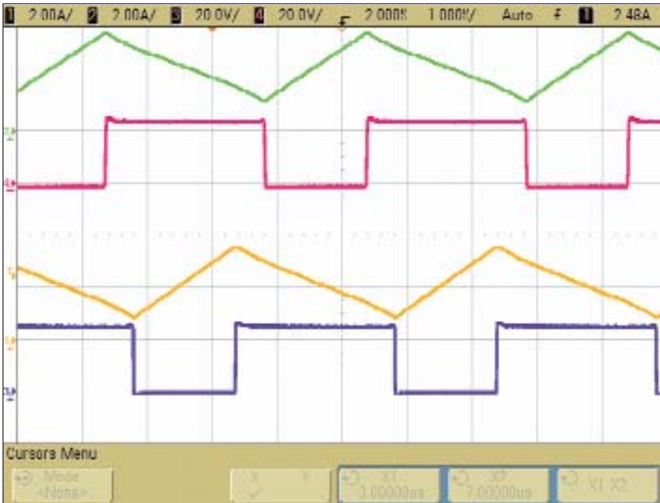
Рис. 3. Временная диаграмма двухфазного повышающего преобразователя. Кривые 1 и 2 — токи на L1 и L2 (2 A/Div), кривые 3 и 4 — это соответствующие напряжения на истоках Q1 и Q2 (20 В/Div). Разница фаз \alpha = 180^\circ измерена между задними фронтами сигналов, проходящих через Q1 и Q2
