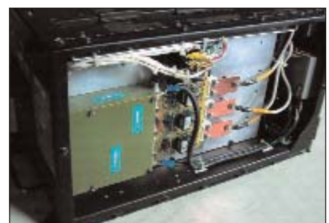
Рис. 11. Вид ПСН с использованием заказного конденсатора
