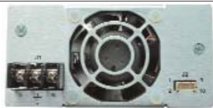
Рис. 7. Правильно установленная защитная крышка вентилятора уменьшает шум вентилятора
