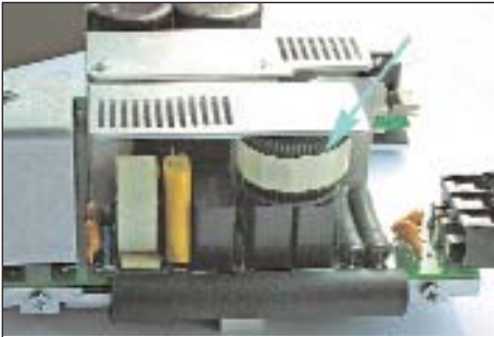
Рис. 6. Установка дросселей на корпусах фильтрующих конденсаторов — разумное конструкторское решение
