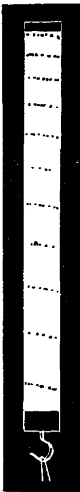
Рис. 24. Падающее тело с отметками времени и их обработка с обычными ошибками опыта и отсчета. Этот опыт показывает прежде всего, что измерение второй производной — дело довольно неприятное, пока не применяется фотографическая регистрация.
