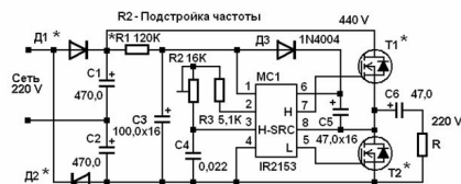
Рис. 50. Полная электрическая схема ПРИНЦЕССА-СД . Удобочитаемый вариант. Диоды и полупроводники – любые подходящие. R1 – подборка при подгонке 16 Вольт на ноге 1 микросхемы. Максимальная мощность на нагрузке R определяется типами диодов, полупроводников, и номиналами конденсаторов C1, C2 и C6 . В принципе схема может качать несколько киловатт.
