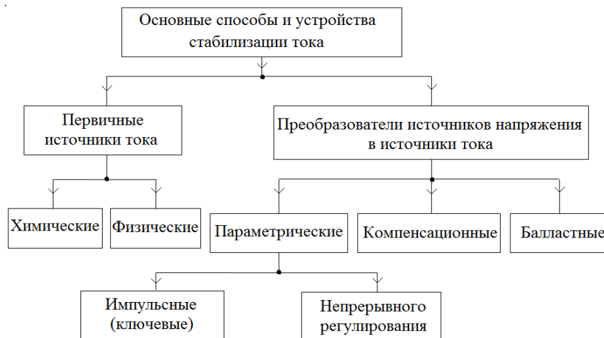
Рисунок 1.2 – Основные способы и устройства стабилизации тока
