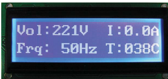
图 8.8c EG8010 连接 12832 工作时液晶屏显示信息
