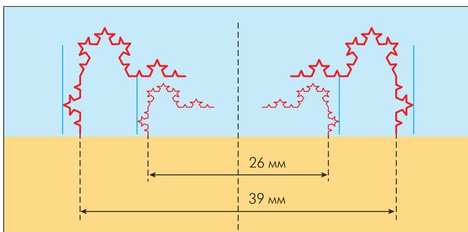
**Рис.9. Пример двухдиапазонной (2,45 и 5,25 Гц) антенной решетки**
