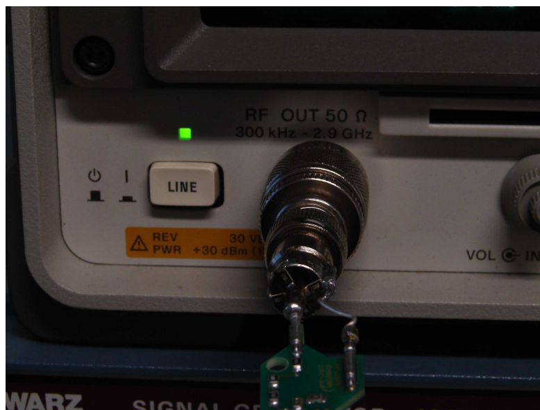
Abbildung 10: Anschluss des Tastkops an den Tracking-Generator
