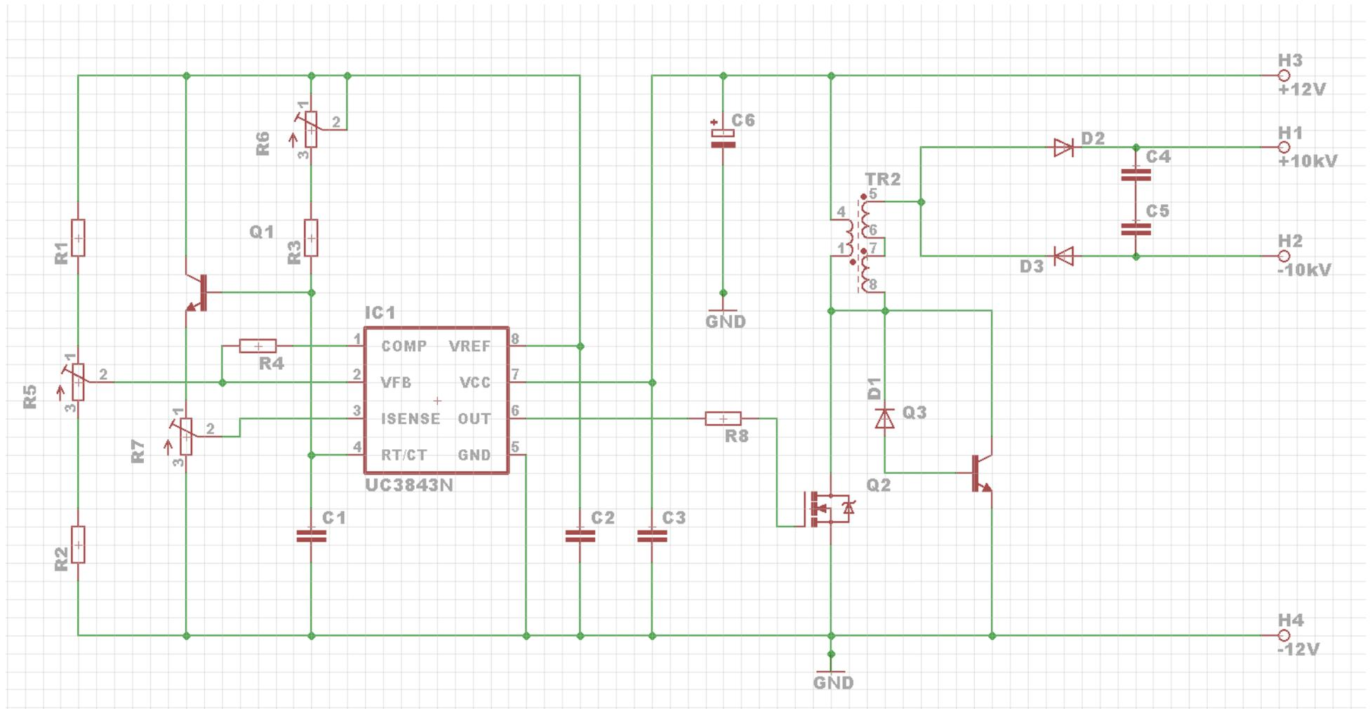
Генератор собран на микросхеме UC3843 с регулируемой скважностью. Выход сделан по вилке Авраменко, что предотвращает короткие замыкания при случайном попадании воды на контакты стакан-конденсатора. В качестве силового ключа Q2 использовал IRF640. Транзистор Q3 в связке диодом D1 образует аналог стабилитрона на 65 вольт который значительно повышает КПД и служит для стабилизации высокого напряжения. При длительной работе Q3 необходимо снабдить небольшим радиатором. Q2 работает без нагрева.
